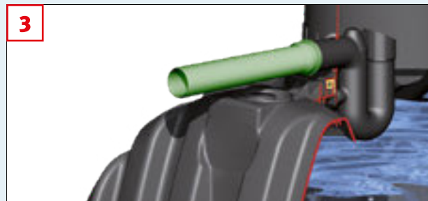
3 La capa de partículas en suspensión se elimina por el rebosadero instalado en el depósito cuando excede el máximo de su capacidad.
