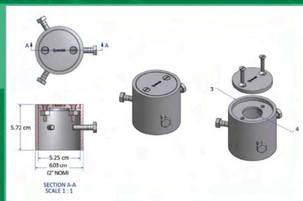
Tapón Registro de Ø 2" nom. en acero inoxidable. Heavy duty Ø 2" nom. stainless steel Cleanout.
