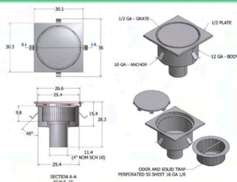
Coladera cuadrada 30x30 cm con salida fondo Ø 4" nom. Con trampa de olores y sólidos removible. Tapa sólida 1/2" acero inoxidable (tráfico pesado)
