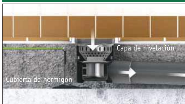
Hormigón y baldosas sin membrana
